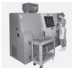
Direktmontage Dryflo® auf Maschine (400 – 1400m 3 /h) Assemblage direct Dryflo® sur l'appareil Direct assembly Dryflo® on machine
